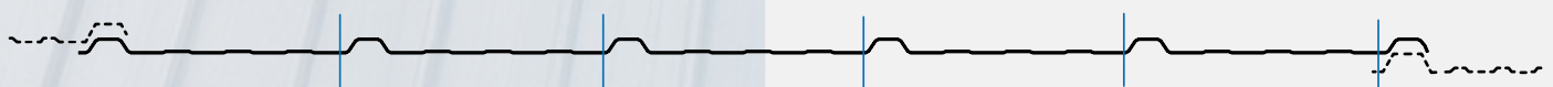
Sóng âm được cố định bằng 5 vít dọc theo mỗi sóng / Valley fix 5 fasteners adjacent to each rib
