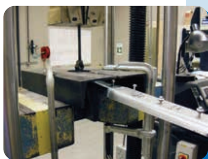
Thí nghiệm chịu kéo Tensile withdrawal test
